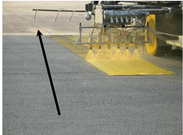
**FIGURE 6-54. MECHANICAL POINTER.**
