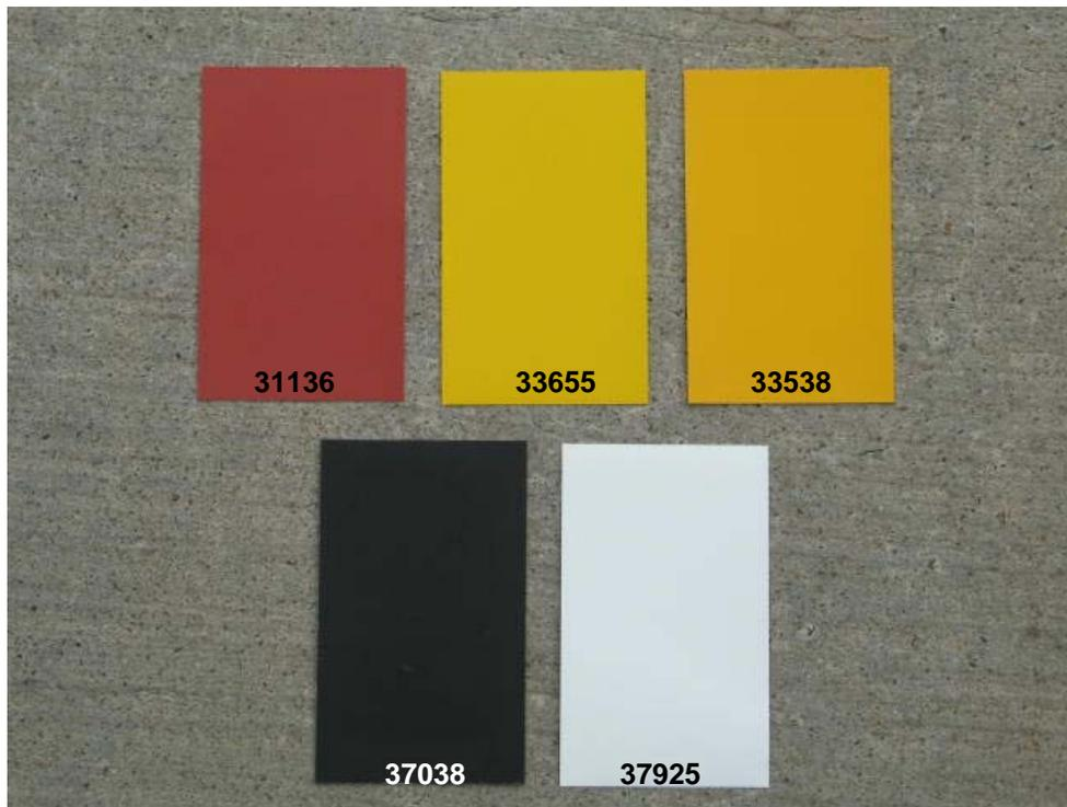
**FIGURE 7-11. FEDERAL STANDARD 595B COLORS FOR AIRFIELD MARKINGS**
