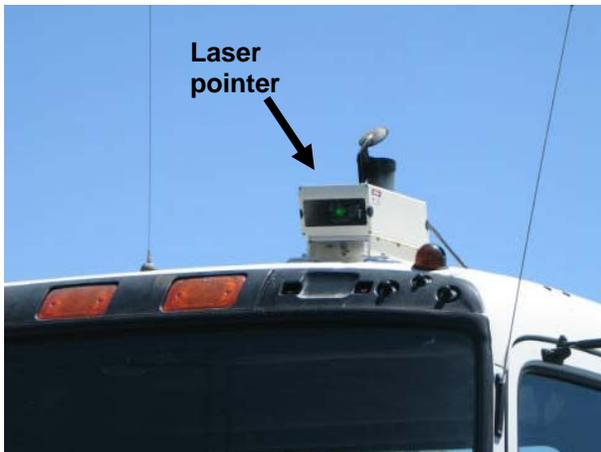
**FIGURE 6-53. LASER POINTER.**
