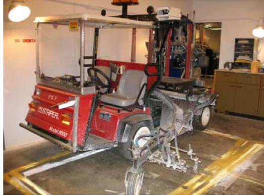
**FIGURE 6-27. OTHER LONG-LINE STRIPING EQUIPMENT.**
