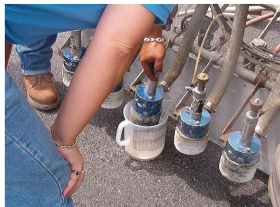
**FIGURE 6-60. CALIBRATION OF GLASS BEAD GUNS.**
