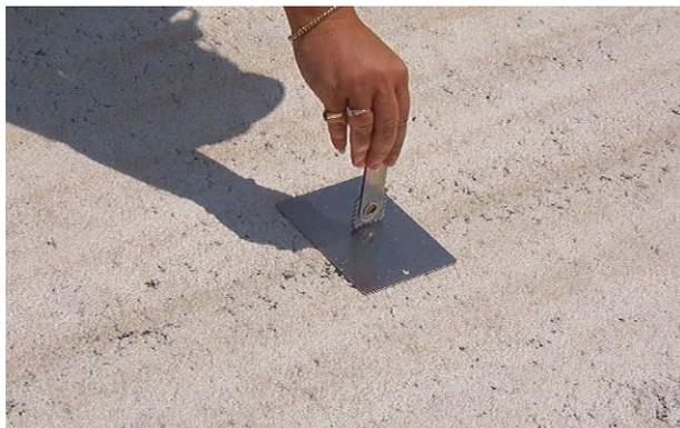
**FIGURE 6-67. WET FILM GAUGE ON A METAL COUPON.**
