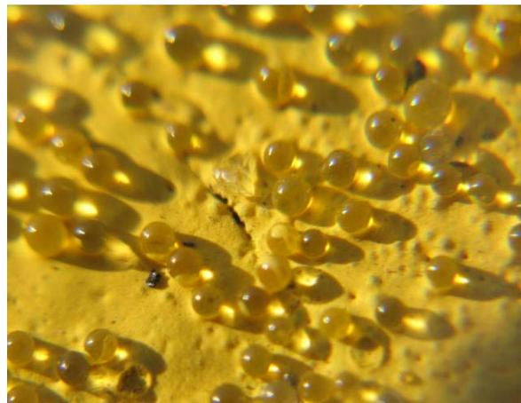
**FIGURE 3-11. POOR TYPE IV BEAD EMBEDMENT.**
