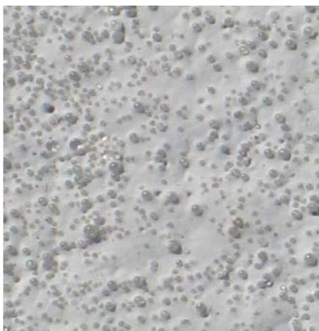
**FIGURE 3-7. POOR BEAD DISTRIBUTION OF TYPE III BEADS.**
