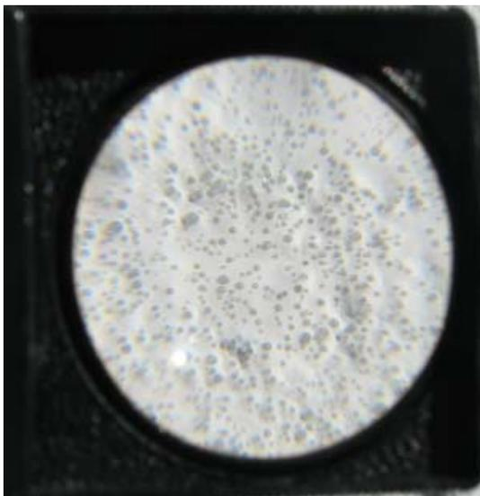
**FIGURE 3-4. POOR TYPE I BEAD DISTRIBUTION; READINGS AVERAGED ONLY 135 mcd/m<sup>2</sup>/lux.**
