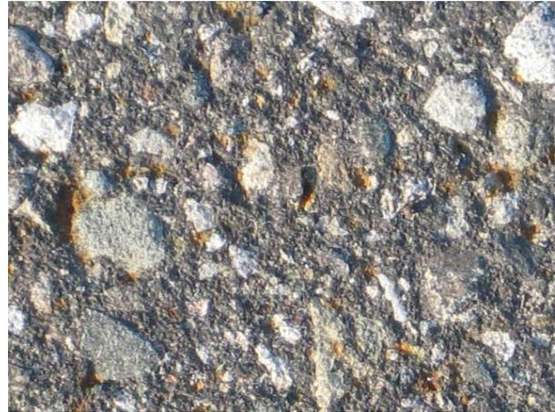
**FIGURE 5-15. A CLOSE-UP OF FIGURE 5-14 SHOWS RUST AREAS WHERE SHOT REMAINED.**
